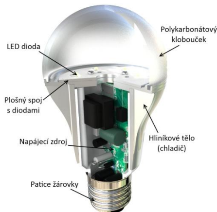
Obrázek 23 - LED "žárovka" konstrukce [15]
