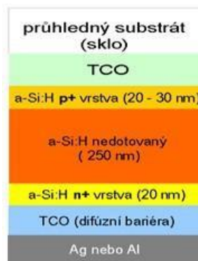
Obr. 10 Struktura amorfního článku [31]
