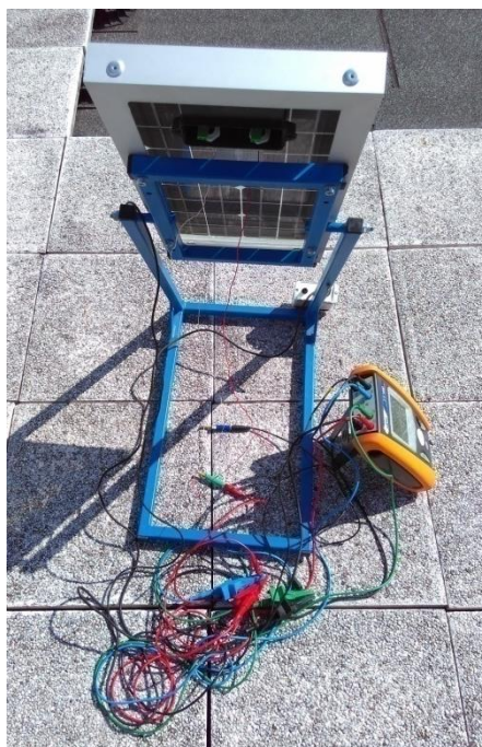
Obr. 36 Měření analyzátozem I-V 400
