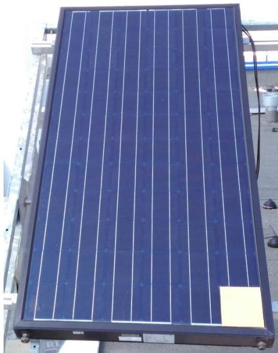
Obr. 42 Ukázka zastínění měřeného panelu (zastíněn jeden článek)
