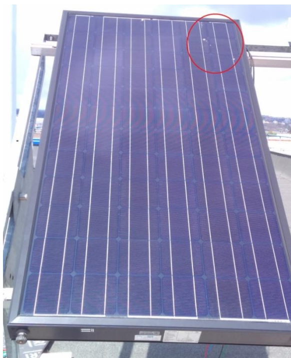
Obr. 48 Měřený fotovoltaický panel pokrytý ptačím trusem
