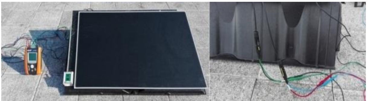
Obr. 6.3: Fotografie CIGS panelu umístěného na pomocném přípravku (vlevo) s detailem připojení analyzátoru k panelu (vpravo)
