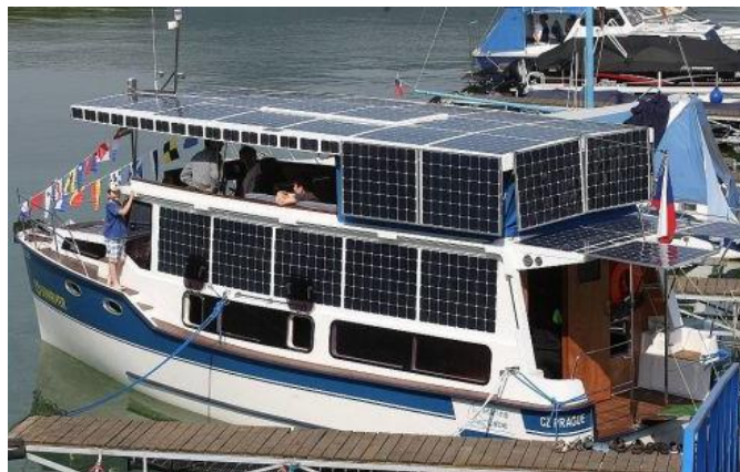
Obr. 23: Lod s fotovoltaickým systémem [15]
