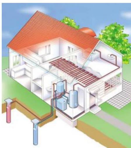
Obr. 1.4 Schéma TČ voda - voda [3]
