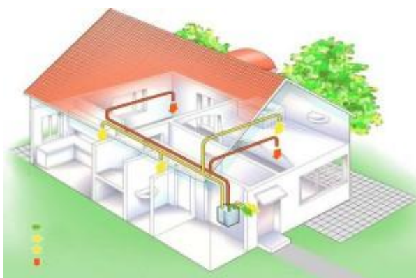
Obr. 1.2 Schéma TČ vzduch - vzduch [3]
