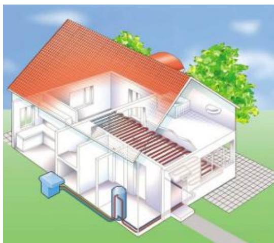
Obr. 1.3 Schéma TČ vzduch – voda [3]
