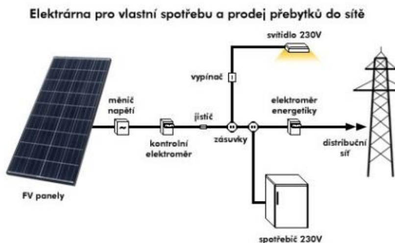
Obr.2 Elektrárna pro vlastní spotřebu a prodej přebytků do sítě [2]
