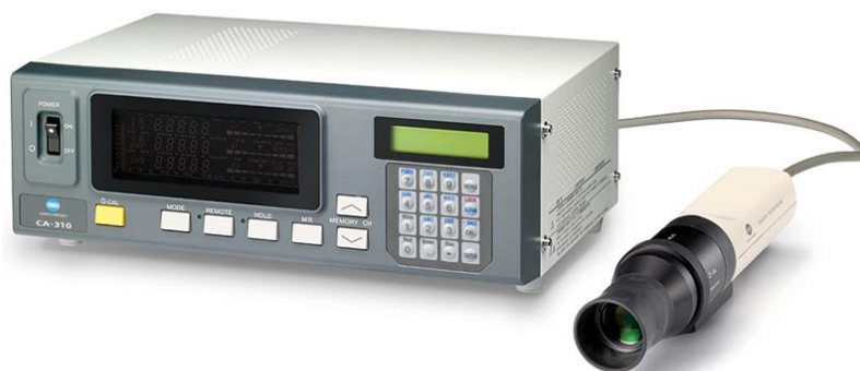
Obr. 4 Kolorimetrická sonda – Konica Minolta CA-310. Převzato z [3]
