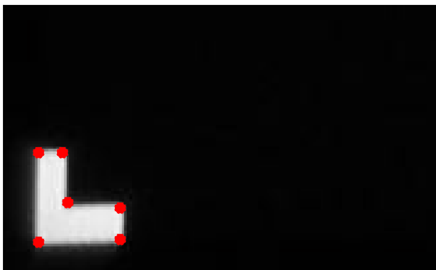
Obr. 13 Ukázka nalezeného levého dolního rohu na fotografii zobrazovače
