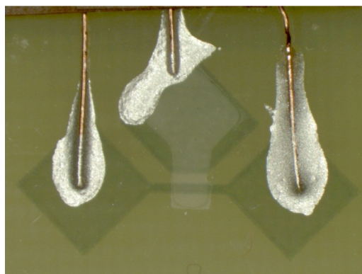
Obr. 6.8 OECT, Varianta B: laterální topologie, plošně úspornější topologie s kontakty otočenými o 45^\circ , v sadě 3 různé vzdálenosti gate-channel a 3 různé šířky kanálu
