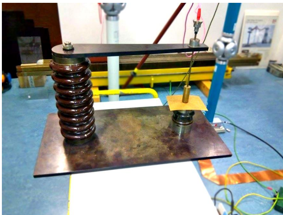
Obr. 5.1 Elektrodotové uspořádání pro měření elektrické pevnosti
