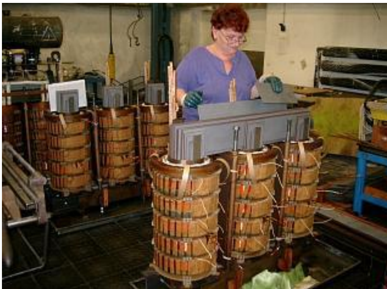
Obr. 4.5 Skládání magnetického jádra
