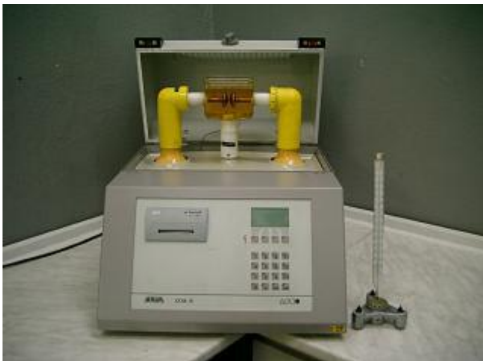
Obr. 3.2 Zkoušečka oleje Baur Dieltest TDA 100
