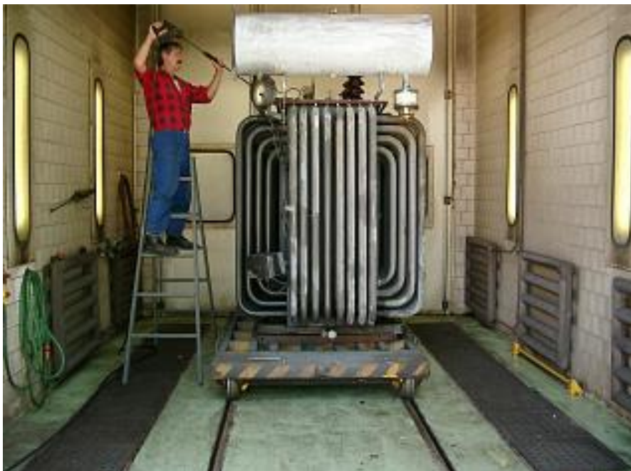
Obr. 4.7 Příprava na lakování
