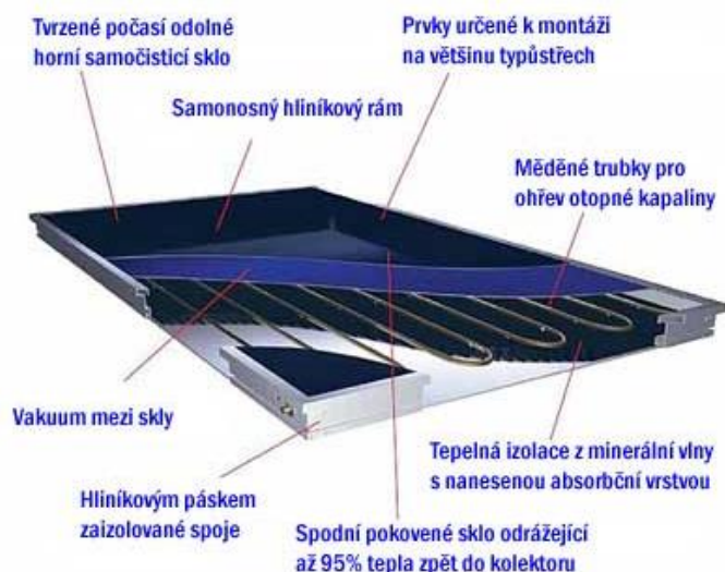
Obr. 2.6 Schéma deskového vakuového solárního kolektoru [27]
