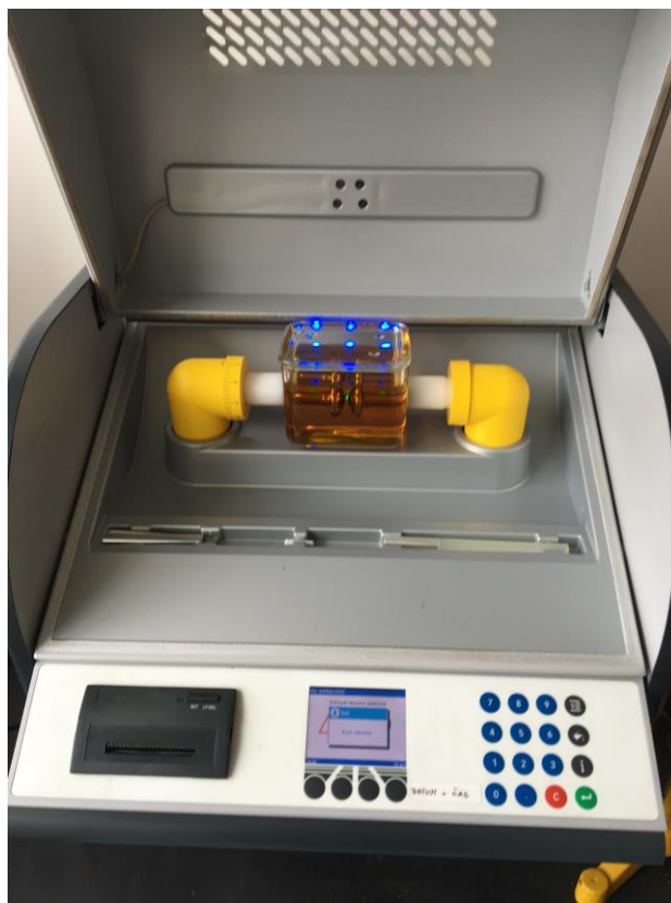
Obr. 3.1.1 Měřicí přístroj na zjištění průrazného napětí Baur DTA100C
