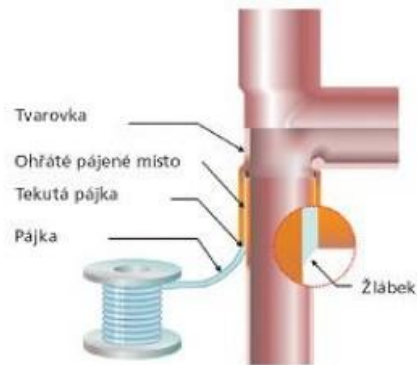
Obr. 1.1 Spojování pájením (převzato z [7])
