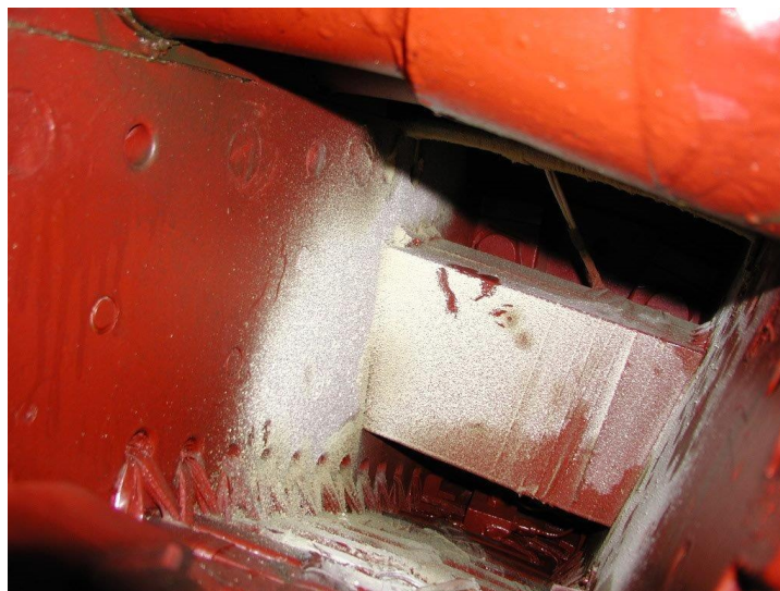
Obrázek 3: Izolace ve formě bílého prachu, sedřená z čel vinutí třením a vibracemi [7]
