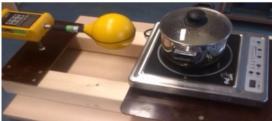
Obr.č.11: Foto z měření na indukčním vařiči: uspořádání vařiče a sondy
