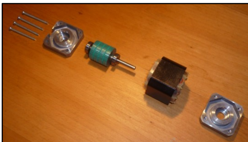
Obr. 12 Konstrukce krokového motoru pro pohon starší jehličkové tiskárny (převzato z [36])
