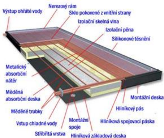
Obrázek 5: Plochý deskový kolektor [13]
