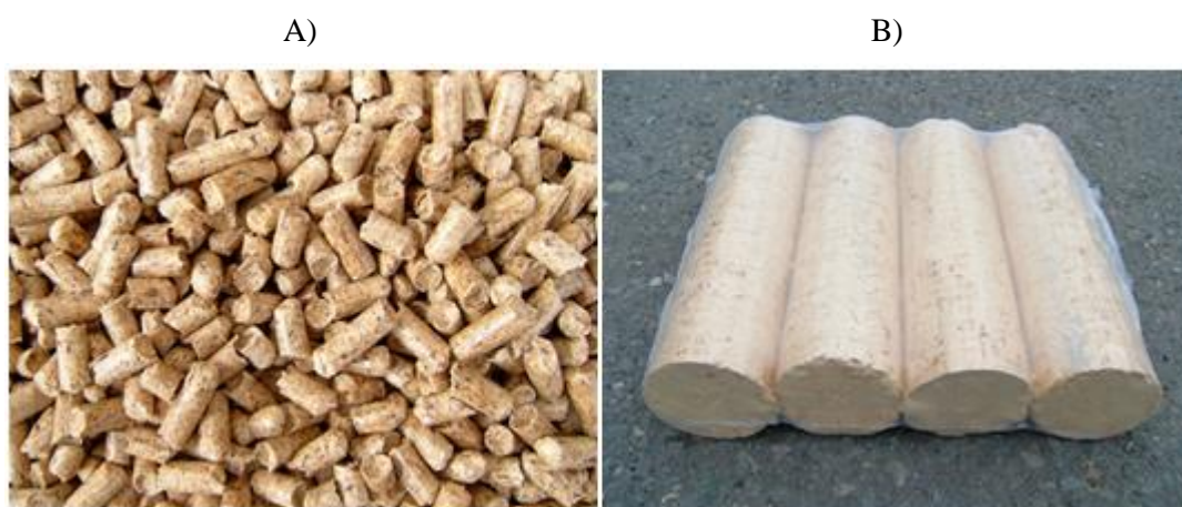
Obrázek 11: A) pelety, B) brikety [20]
