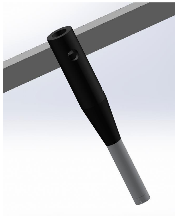
Obr. 7.15: Detail uchycení měřícího mikrofonu
