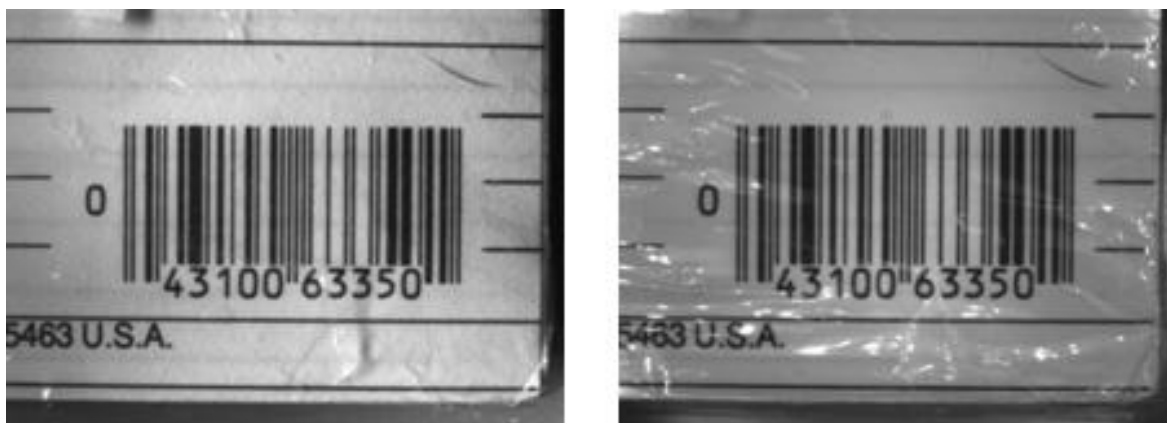
Obr. 2.1 Vlevo je vyfocený kód při dodržení všech 3 podmínek, vpravo pouze při dodržení prvních dvou. [2]
