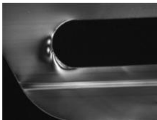
Obr. 2.14 Průhledný plastový držák na plechovky při použití polarizovaného světla [3]
