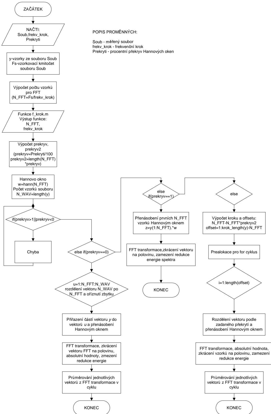
Obr. D.2: Vývojový diagram kódu pro výpočet FFT se zadaným překryvem
