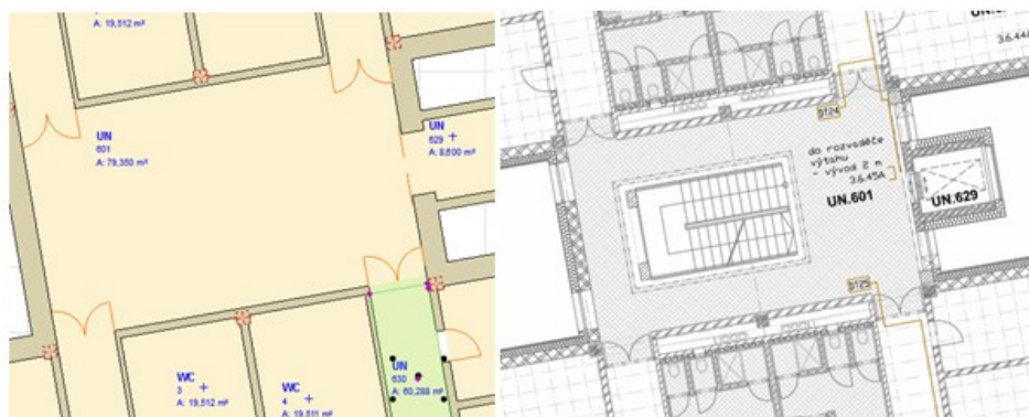
Obrázek 5.3 Chybějící schodiště ve 3D data setu.
