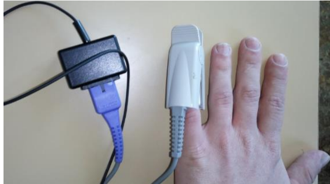
Obr. 10 Senzor pro snímání tepu (vyfoceno v laboratoři)
