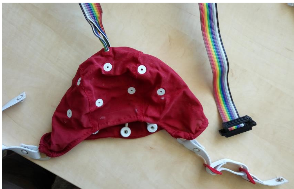
Obr. 9 EEG čepice (vyfoceno v laboratoři)
