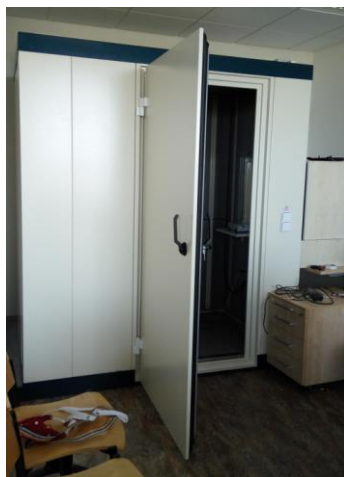
Obr. 7 Zvukotěsná komora (vyfoceno v laboratoři)
