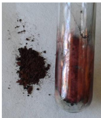
Obr. 4 Srovnání oxidu měďnatého a měďného zrcátka
