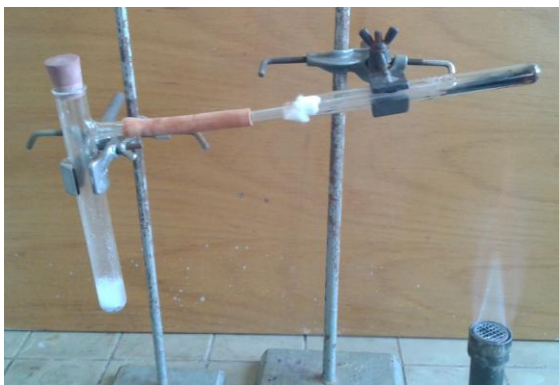
Obr. 3 Aparatura pro redukcí oxidu měďnatého na měď
