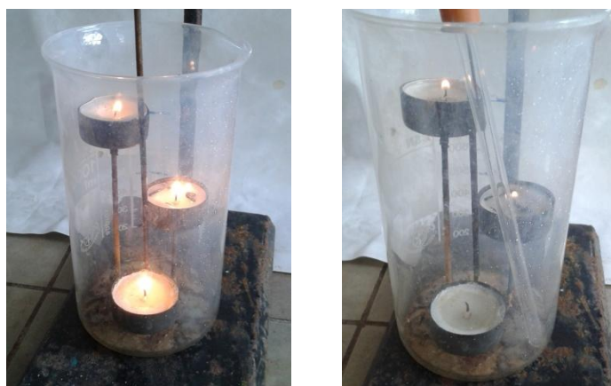
Obr. 5 Stojan se svíčkami v kádince před a po zavedení oxidu uhličitého
