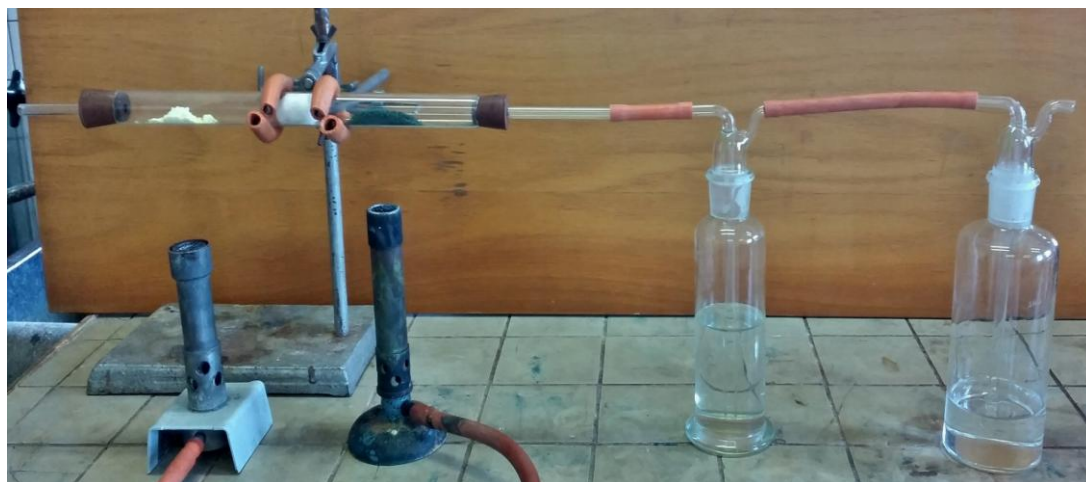
Obr. 18 Aparatura pro kontaktní oxidaci oxidu siřičitého na oxid sírový
