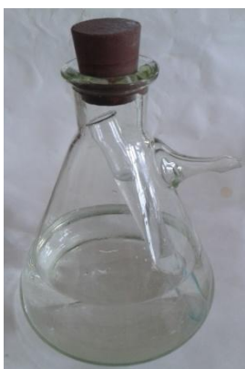
Obr. 7 Model kapalinového hasicího přístroje
