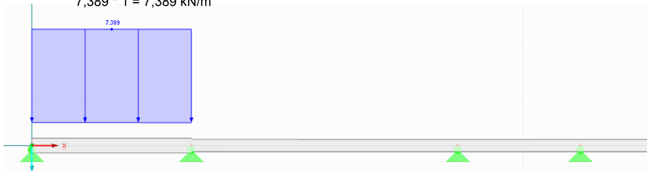
Obr. 4.7. Zatížení na části stropu v 1.NP - 6.ZS
