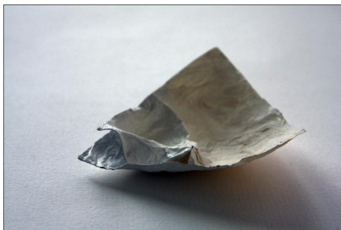
Příloha č. VIII, část papírové polokoule vyztužená balakrylem, foto: M. Veselá
