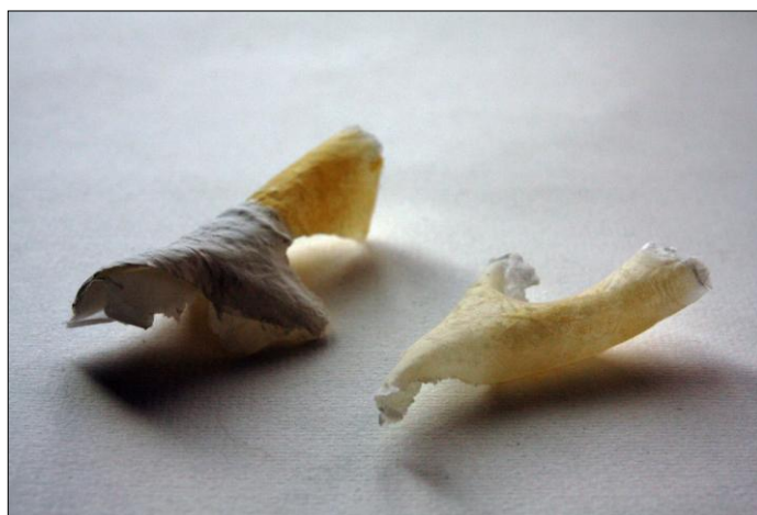
Příloha č. IX, vyztužení papíru vodním sklem, foto: M. Veselá
