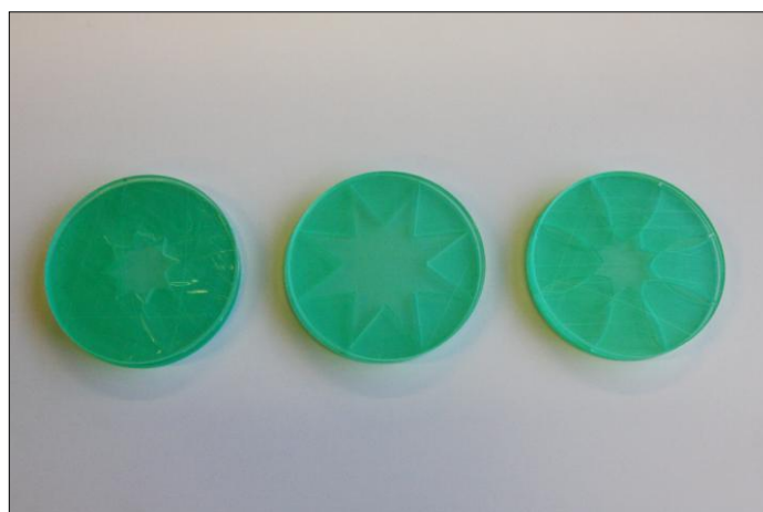
Příloha č. XXIII, vyřezané kruhy s ochrannou fólií před montáží, foto: M. Veselá
