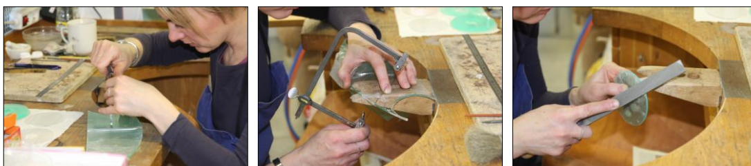
Příloha č. X b),c),d) vyřezávání a pilování kruhu, foto: T. Jurusová
