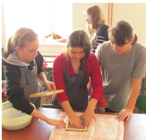
Obr. 18 - Výroba papíru - vyklopení z rámu
