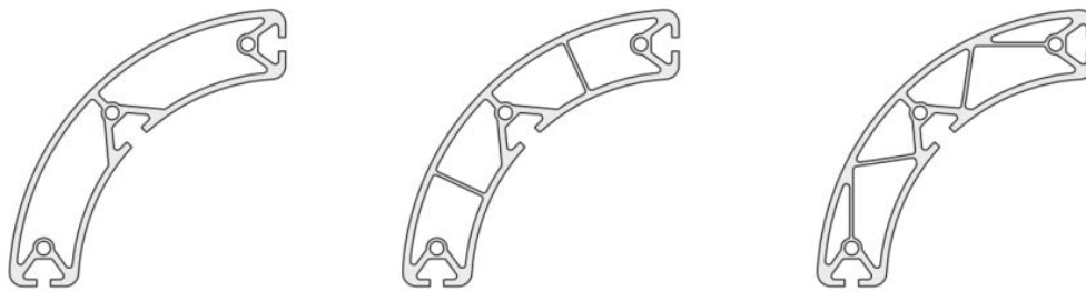
Obrázek 7: Navrhovaný tvar hliníkových profilů
