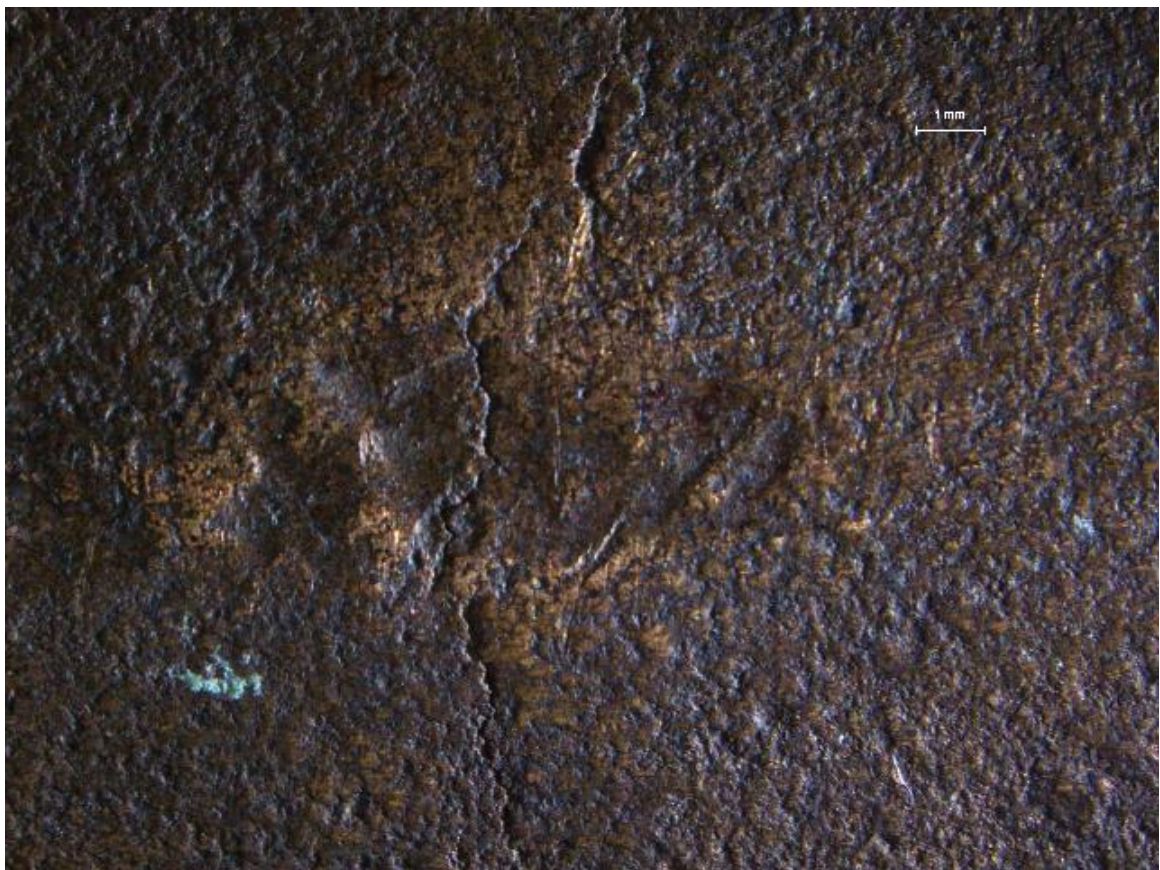
Obr. 93 Prasklina s prohlubní v kovu; meč č. 106087 (NM; stereomikroskop se zvětšením 0,75x; hrot směrem doleva)
