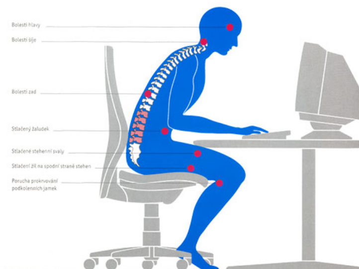
Obr. č. 20. Nesprávný sed při práci s PC s jeho následky. ( http://www.kancelarsky-nabytek-praha.cz/ergonomie.htm )
