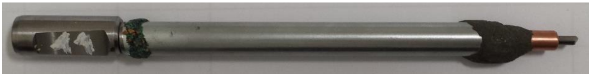
Obrázek 20: Pouzdro navlečené na vrtací rouře dělového vrtáku
