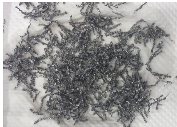
Obrázek 54: ISO 5.1- kuželovitá dlouhá; v_c=75 m/min; 2 m; n=7960 ot/min; f=0,02 mm/ot; bez úpravy
