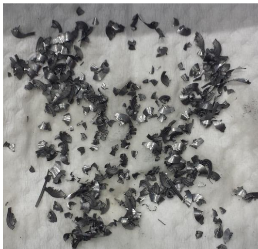
Obrázek 39: ISO 6.2- obloučkovitá dělená; nástroj č. 1; v_c=60 \text{ m/min} ; 2 \text{ m} ; n=6400 \text{ ot/min} ; f=0,02 \text{ mm/ot} ; r_N=13 \mu\text{m}
