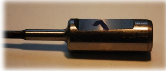
Obrázek 2: Upínací stopka dělového vrtáku
