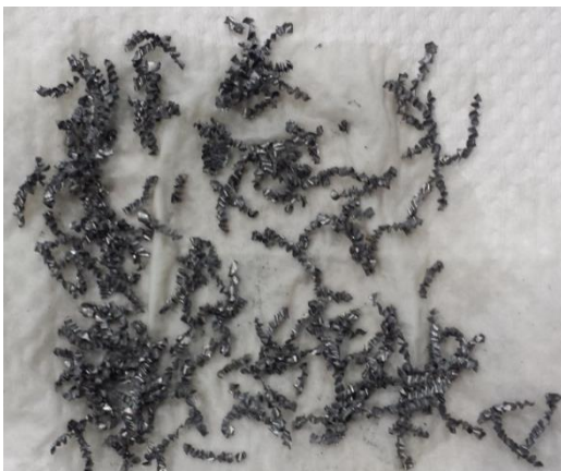
Obrázek 53: ISO 5.2- kuželovitá krátká; v_c=60 m/min; 2 m; n=6400 ot/min; f=0,02 mm/ot; bez úpravy
