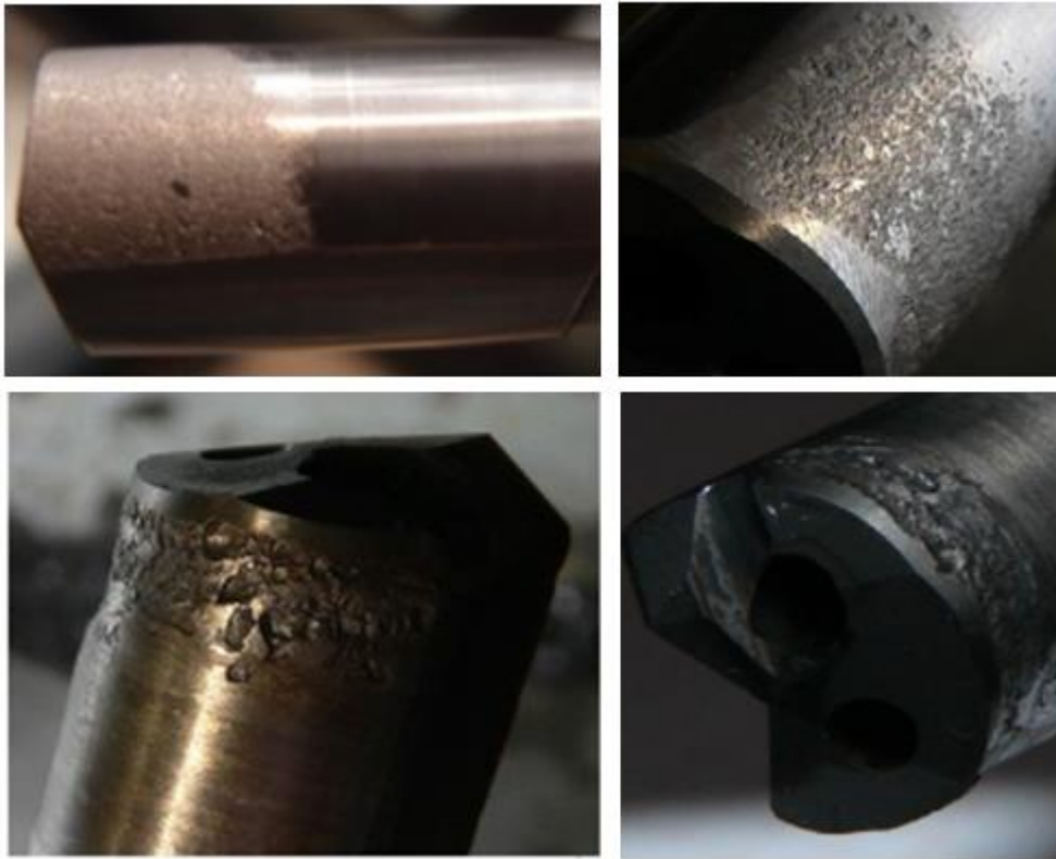
Obrázek 14: Vzniklý cobalt leaching na vodících plochách [10]
