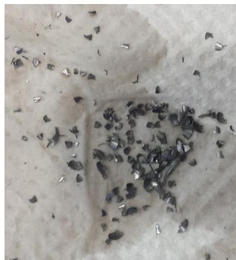
Obrázek 40: ISO 6.2- obloučkovitá dělená; nástroj č. 12 v_c=60 \text{ m/min} ; 2 \text{ m} ; n=6400 \text{ ot/min} ; f=0,02 \text{ mm/ot} ; r_N=3 \mu\text{m}
