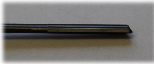
Obrázek 3: Vzniklý podbrus s válcovou fazetkou
