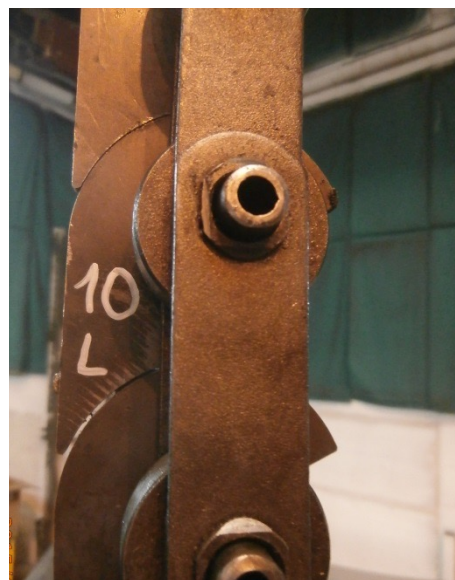
Obr.č.66 nepřesnosti článků pásu[5]
