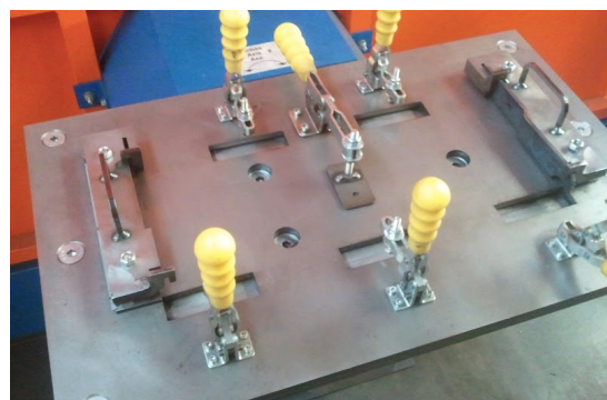
Obr.č.31 kontrolní přípravek pro článek pásu [5]
