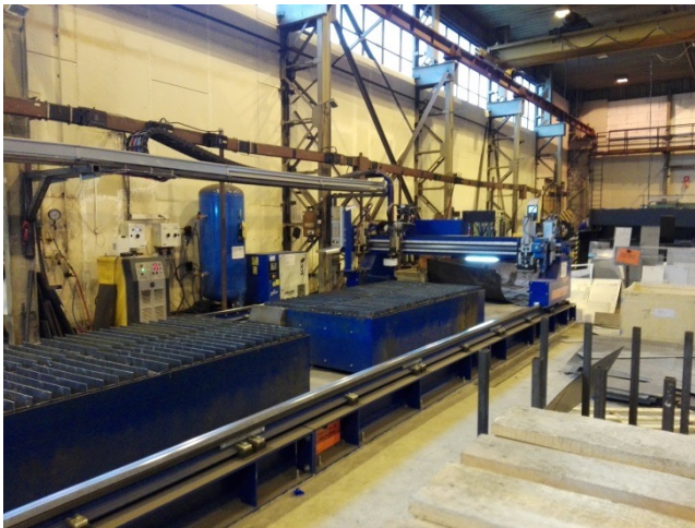
Obr.č.20 dělirna - pálicí stroje [5]
