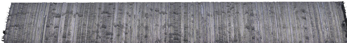
Obrázek č. 5.40: Scan povrchu čípku pro utvařeč 8A a v_f=192 [mm/min] – 3. opakování
