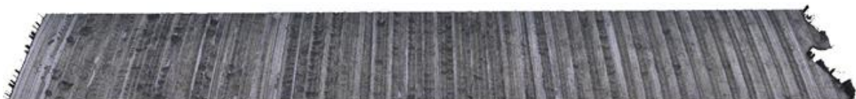
Obrázek č. 5.12: Scan povrchu čípku pro utvařeč C a v_f=256 [mm/min]
