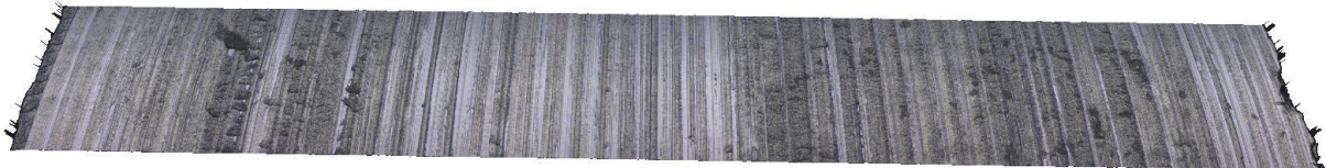
Obrázek č. 5.9: Scan povrchu čípku pro utvařec B a v_f=256 [mm/min]
