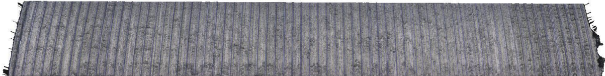
Obrázek č. 5.43: Scan povrchu čípku pro utvařeč 9A a v_f=192 [mm/min]
