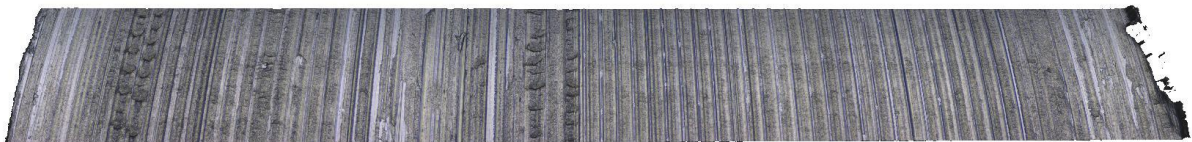
Obrázek č. 5.44: Scan povrchu čípku pro utvařeč 9A a v_f=192 [mm/min] – opakování
