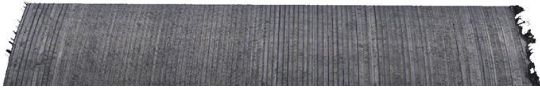
Obrázek č. 5.32: Scan povrchu čípku pro utvařeč 7A a v_f=128 [mm/min] – opakování
