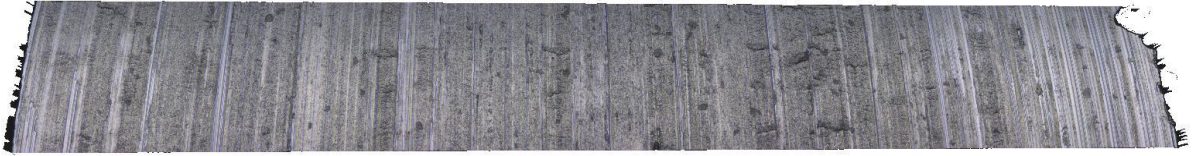
Obrázek č. 5.7: Scan povrchu čípku pro utvařeč A a v_f=384 [mm/min]
