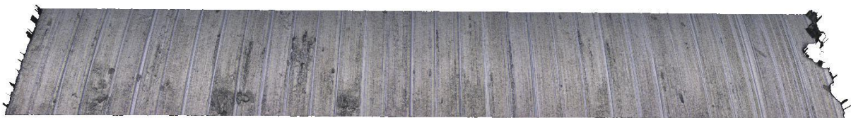
Obrázek č. 5.10: Scan povrchu čípku pro utvařec B a v_f=384 [mm/min]
