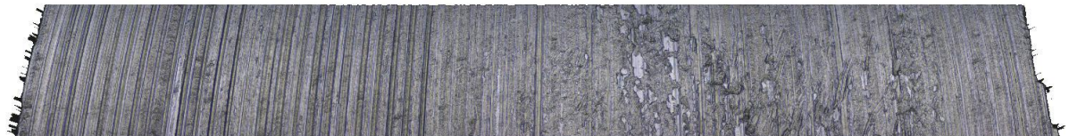
Obrázek č. 5.48: Scan povrchu čípku pro utvařeč 10A a v_f=192 [mm/min] – opakování
