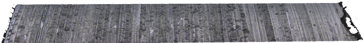
Obrázek č. 5.5: Scan povrchu čípku pro utvařeč A a v_f=120 [mm/min]
