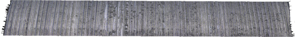
Obrázek č. 5.47: Scan povrchu čípku pro utvařeč 10A a v_f=192 [mm/min]
