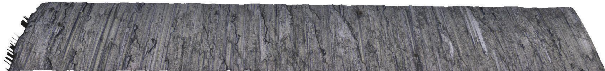
Obrázek č. 5.17: Scan povrchu čípku pro utvařeč E a v_f=120 [mm/min]
