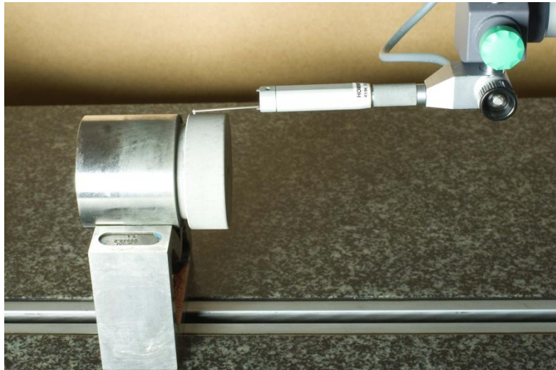
Obrázek 29 Měření drsnosti pomocí dotykové metody
