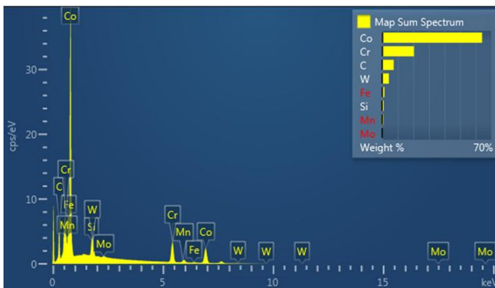
Obrázek 36 Procentuální zastoupení jednotlivých prvků vytvořeného žárového nástřiku
