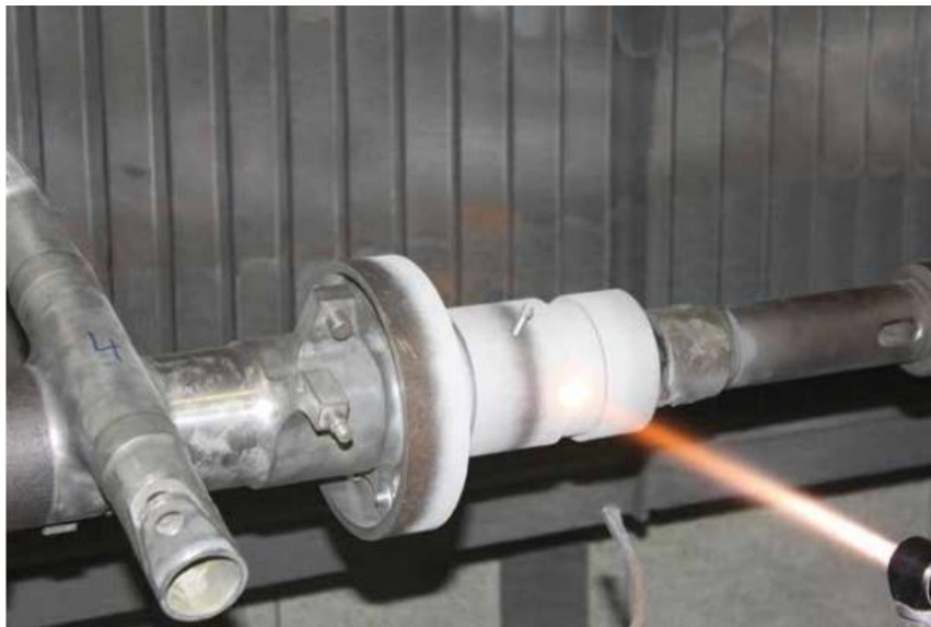
Obrázek 4 Nástřik slitiny stelit 6 na kulový píst [15]
