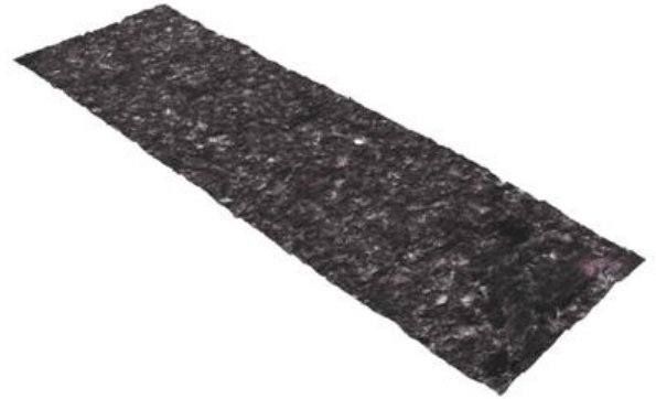
Obrázek 37 Abbottova křivka profilu pro vzorek č. 3 (vlevo), výsledný obrobený povrch (vpravo) - řezné podmínky: v_c = 80 m/min, f_{ot} = 0,3 mm/ot, a_p = 0,175 mm, obrábění za sucha
