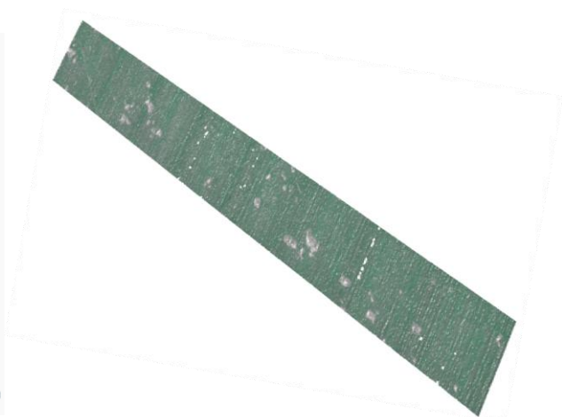
Obrázek 45 Abbottova křivka profilu pro vzorek č. 12 (vlevo), výsledný obrobený povrch (vpravo) - řezné podmínky: v_c = 25 m/min, f_{ot} = 0,3 mm/ot, a_p = 0,2 mm, obrábění za sucha
