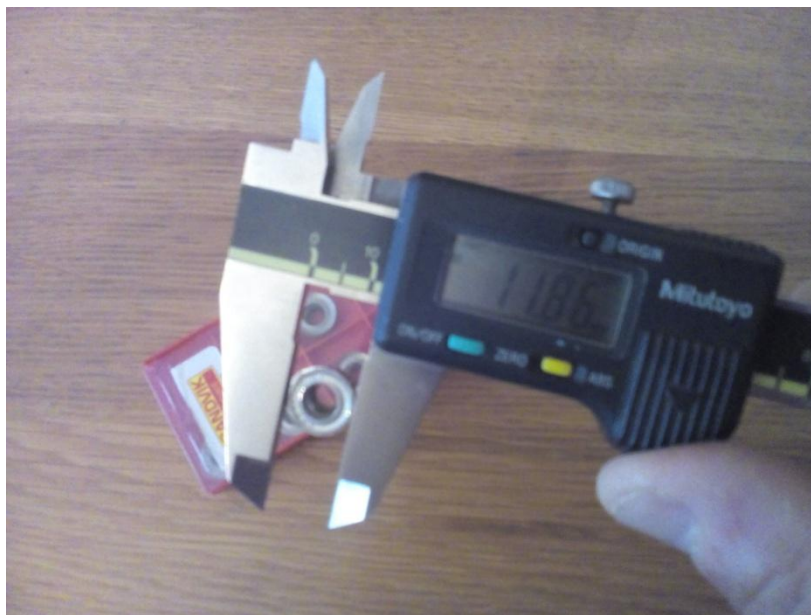
Obrázek 53 Měření průměru VBD
