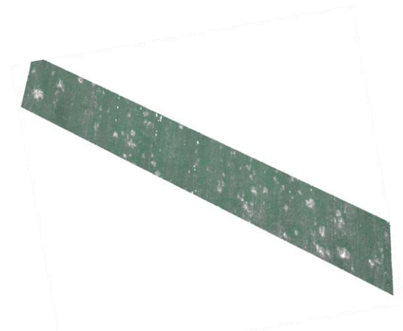
Obrázek 40 Abbottova křivka profilu pro vzorek č. 6 (vlevo), výsledný obrobený povrch (vpravo) - řezné podmínky: v_c = 25 m/min, f_{ot} = 0,3 mm/ot, a_p = 0,2 mm, chlazení při tlaku 100 bar
