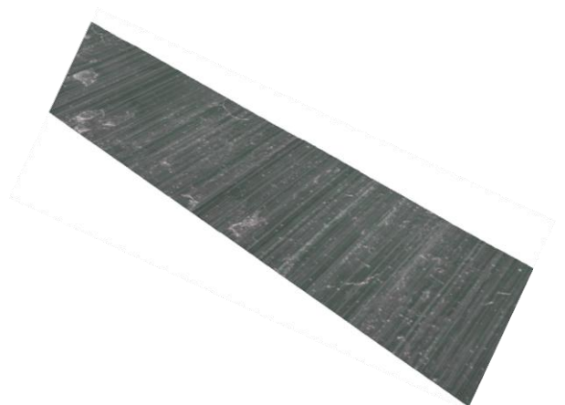
Obrázek 41 Abbottova křivka profilu pro vzorek č. 8 (vlevo), výsledný obrobený povrch (vpravo) - řezné podmínky: v_c = 25 m/min, f_{ot} = 0,3 mm/ot, a_p = 0,225 mm, chlazení při tlaku 100 bar
