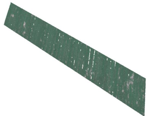
Obrázek 43 Abbottova křivka profilu pro vzorek č. 10 (vlevo), výsledný obrobený povrch (vpravo) - řezné podmínky: v_c = 25 m/min, f_{ot} = 0,15 mm/ot, a_p = 0,2 mm, chlazení při tlaku 100 bar
