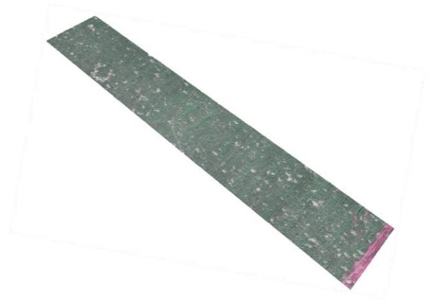
Obrázek 39 Abbottova křivka profilu pro vzorek č. 5 (vlevo), výsledný obrobený povrch (vpravo) - řezné podmínky: v_c = 30 m/min, f_{ot} = 0,3 mm/ot, a_p = 0,25 mm, chlazení při tlaku 100 bar
