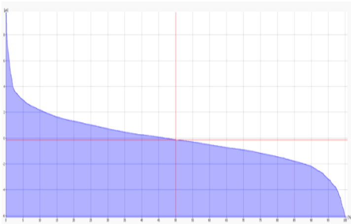
Obrázek 38 Abbottova křivka profilu pro vzorek č. 4 (vlevo), výsledný obrobený povrch (vpravo) - řezné podmínky: v_c = 80 m/min, f_{ot} = 0,3 mm/ot, a_p = 0,25 mm, chlazení při tlaku 100 bar
