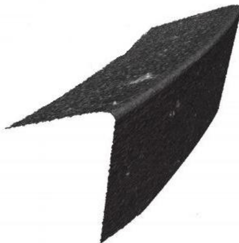
Obrázek 20 Scan řezné hrany VBD s pozitivním úhlem čela \gamma
