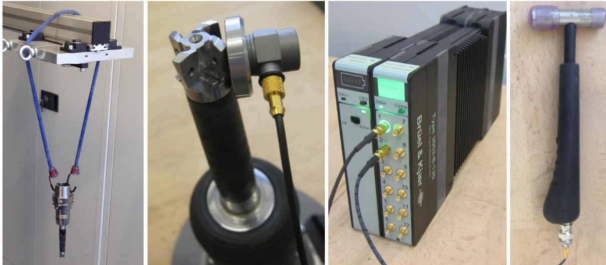
Obrázek č. 13: Modální analýza (zprava): zavěšená n. sestava; umístění IEPE akcelerometru; měřicí karta; rázové kladívko
