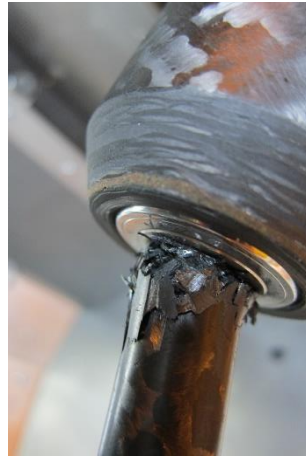
Obrázek č. 10: Destrukce kompozitního nástroje (řada 1.0)
