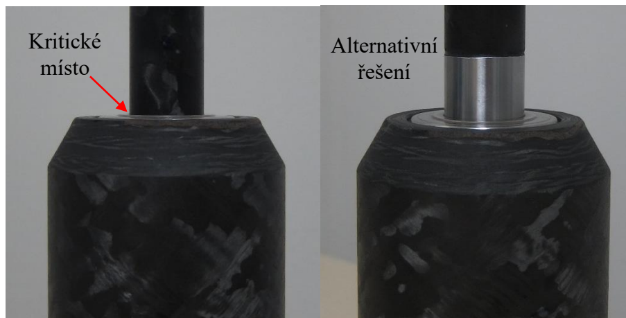
Obrázek č. 7: Nástroj s kompozitní stopkou (řada 1.0)- předchůdce frézy vpravo (řada 2.0) (úprava vysvětlena v kapitole 4.5)
