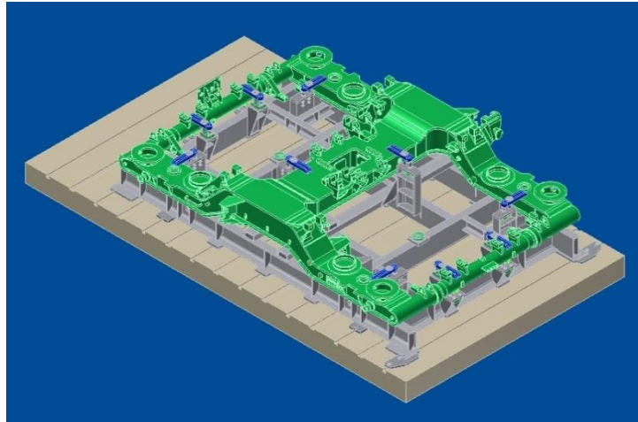
Obr. 3-4 3D CAD model obráběcího přípravku
