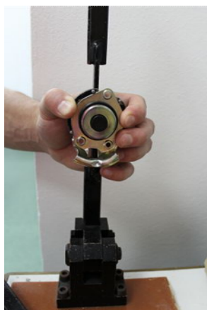
Složený válec nasadit na horní část přípravku
