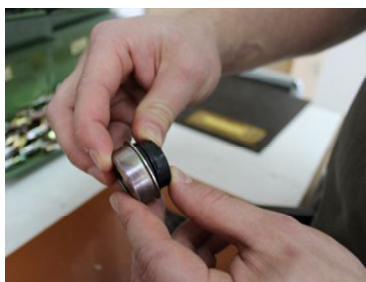
Uchopit píst (s navlečeným malým těsnícím kroužkem) a zasunout do válečku
