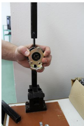
Lícni desku nasunout na horní část přípravku.
