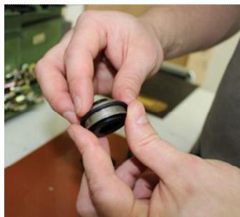
Velký těsnící kroužek navléci na váleček
