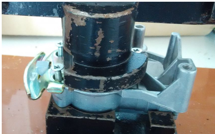
Obrázek 5-4: Sešroubování vzduchového ventilu
