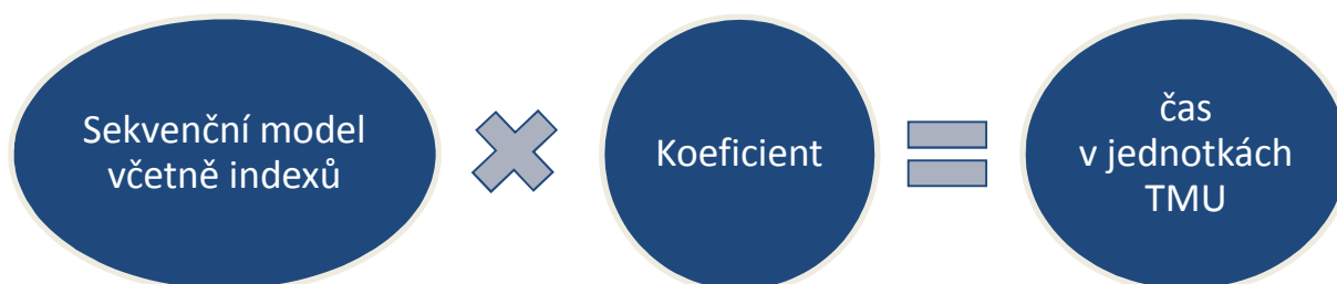
Obrázek 1-8: Vzorec pro výpočet časové normy
