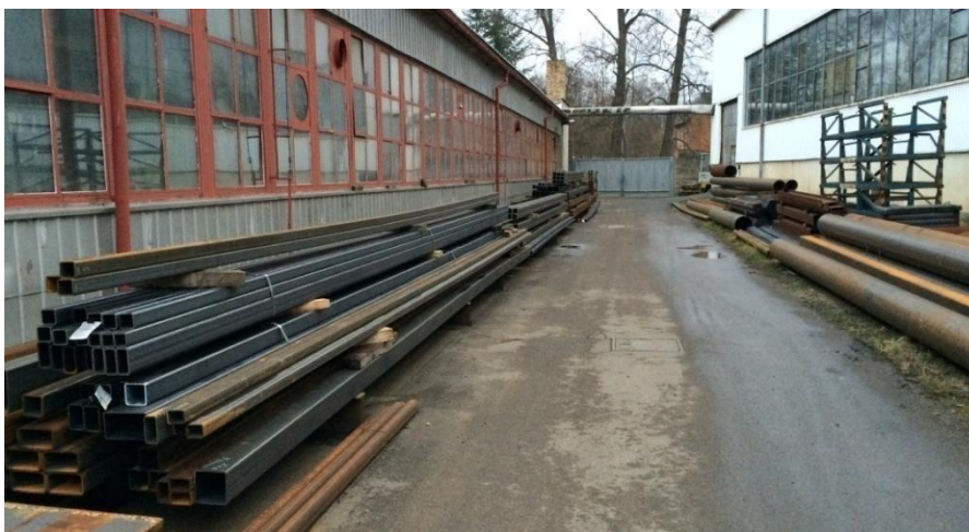
Obr. 17 Skladování tyčového materiálu ve svazcích na zemi
