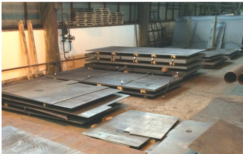
Obr. 14 Skladování plechů ve štosech
