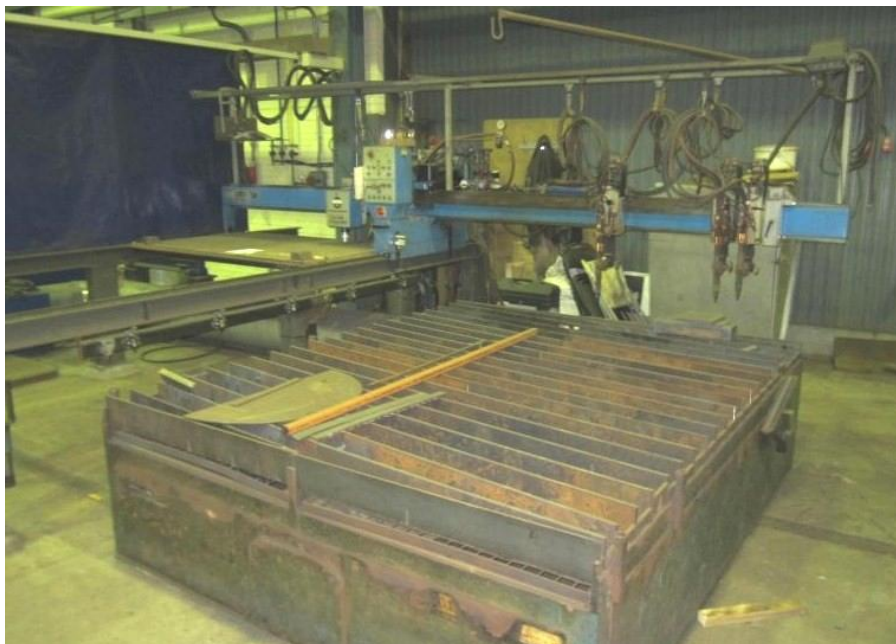
Obr. 18 Pálicí zařízení Corta KS-7
