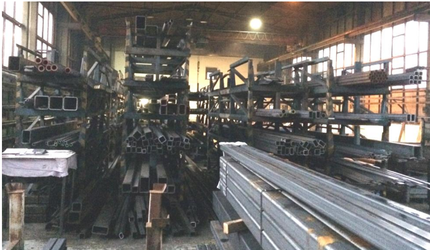
Obr. 16 Skladování tyčového materiálu v regálech
