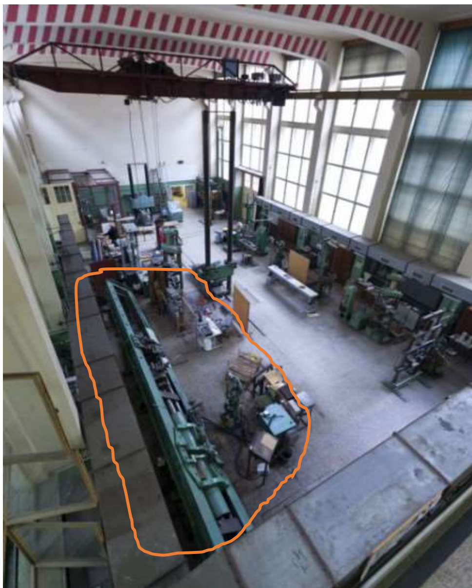
Obr.6-1: Zkušebna s vyznačeným zkušebním strojem AMSLER
