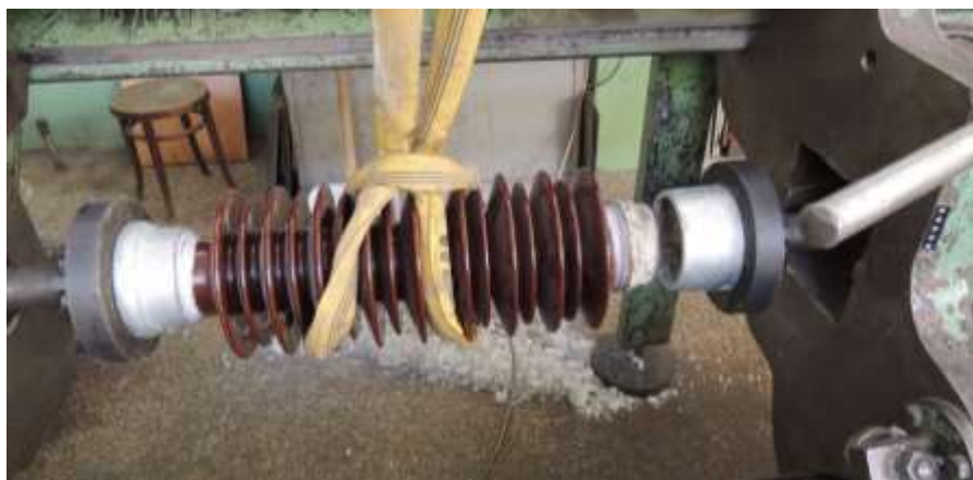
Obr.6.1-3: Tahová zkouška izolátoru ve zkušebním stroji AMSLER
