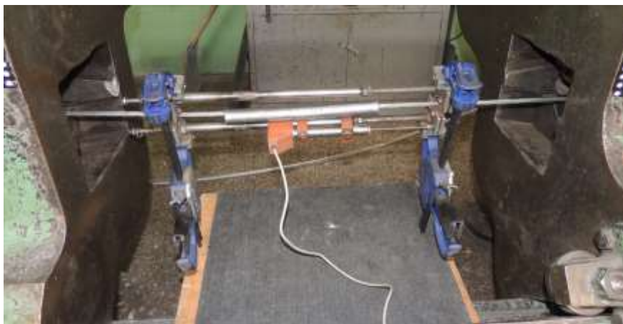
Obr.6.1-1.: Tahová zkouška předpínacího lana ve zkušebním stroji AMSLER
