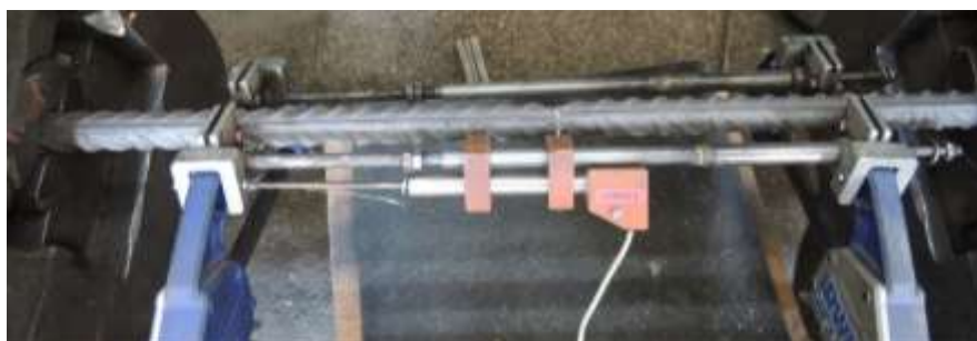
Obr.6.1-2: Tahová zkouška betonářské výztuže ve zkušebním stroji AMSLER
