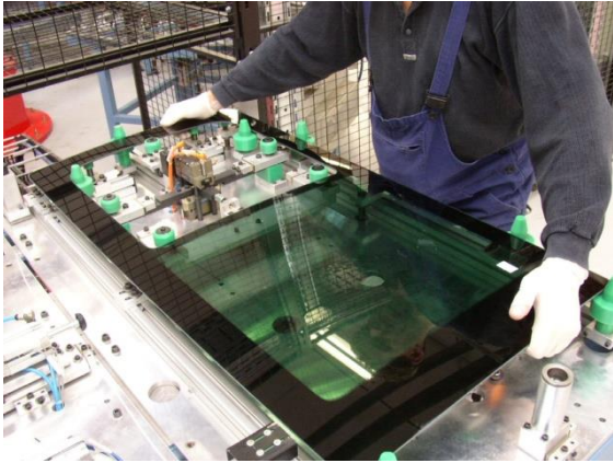
obr. 4.7. Přípravek robota sklo
