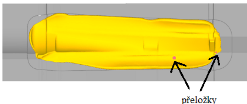
Obr. 61 Identifikace přeložek ve výronku (červení tečky).
