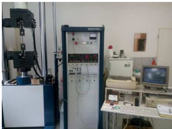
Obr. 18: Trhačí stroj s upnutým zkušebním vzorkem
