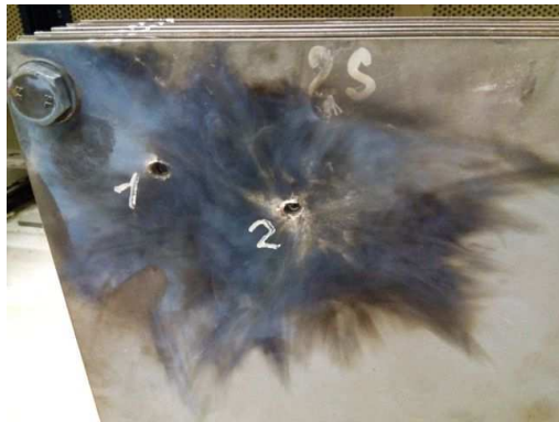
Obr. 30: Balistická zkouška plechu 2S
