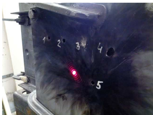
Obr. 29: Balistická zkouška plechu 1S
