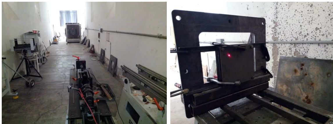
Obr. 28: Tunelová střelnice (vlevo) a upnutí sestavy plechů (vpravo)
