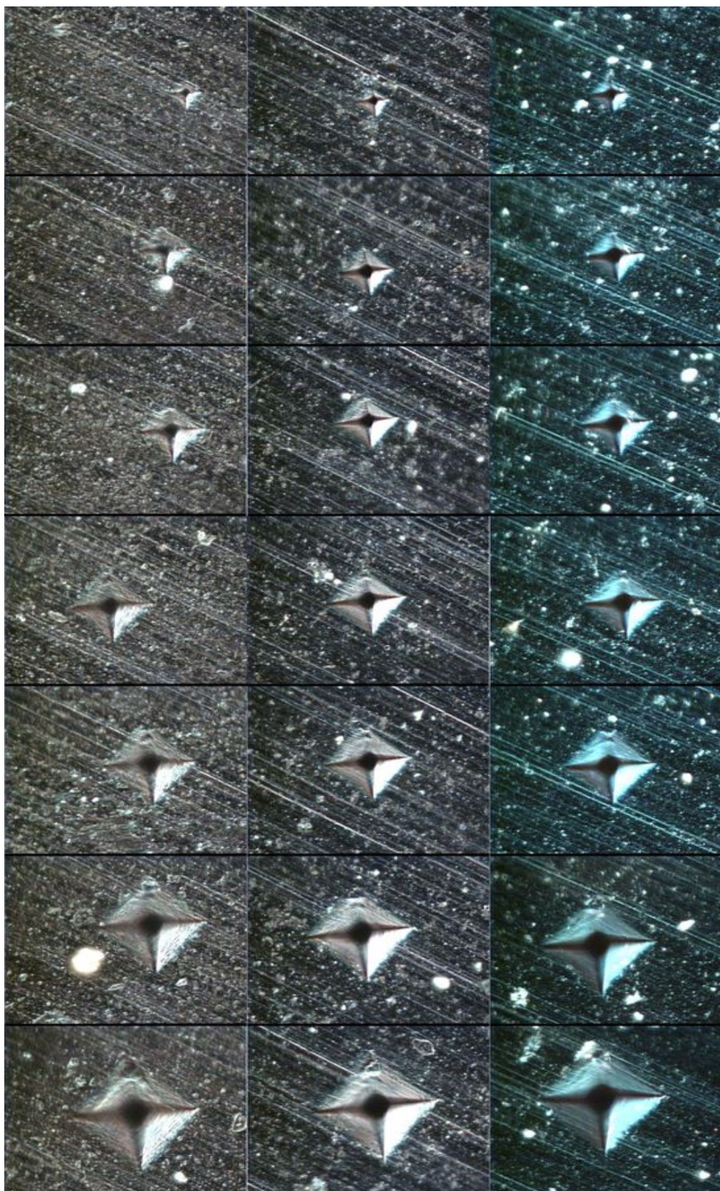
Obr.41: Vtisky Vickersovým indentorem ve vzorku Ti-Al-N – WC před tepelným zatížením (vlevo) a po tepelném zatížení 350 [°C] (uprostřed) a 550 [°C] (vpravo) – ve tmavém poli
