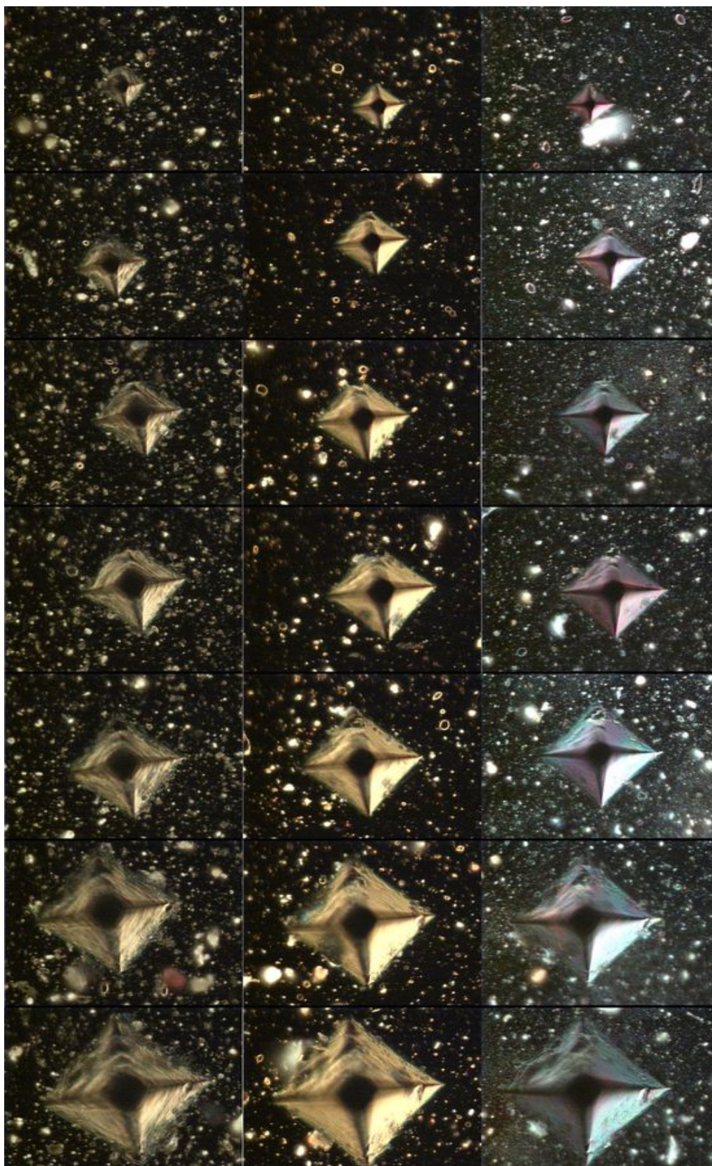
Obr.39: Vtisky Vickersovým indentorem ve vzorku Ti-N – 19 856 před tepelným zatížením (vlevo) a po tepelném zatížení 350 [°C] (uprostřed) a 550 [°C] (vpravo) – ve tmavém poli
