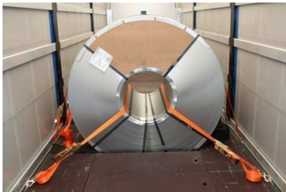
Obrázek 16 – Přeprava svitku pomocí specializovaného vozu a popruhů [8]
