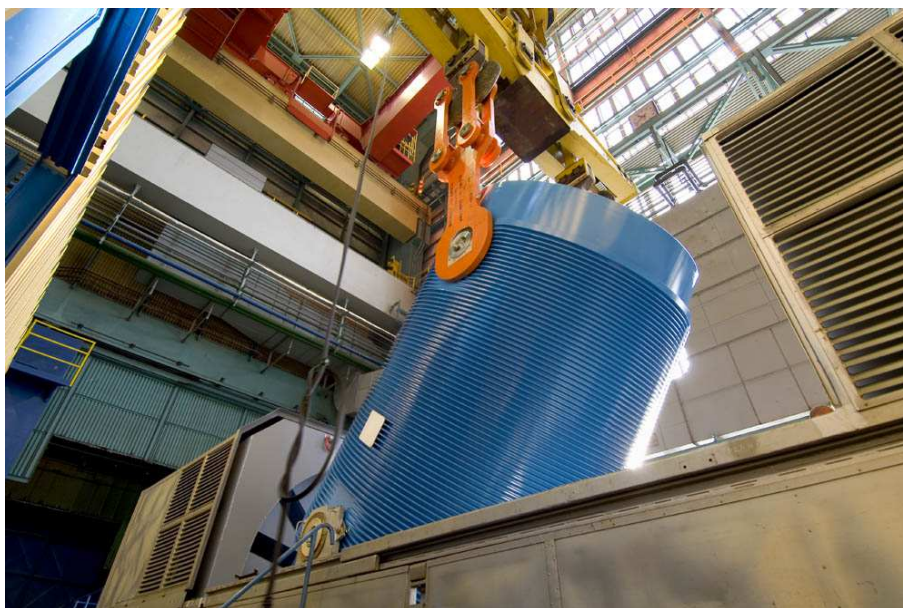
Obrázek 5 – Castor 440 při přepravě speciálním vagónem [4]
