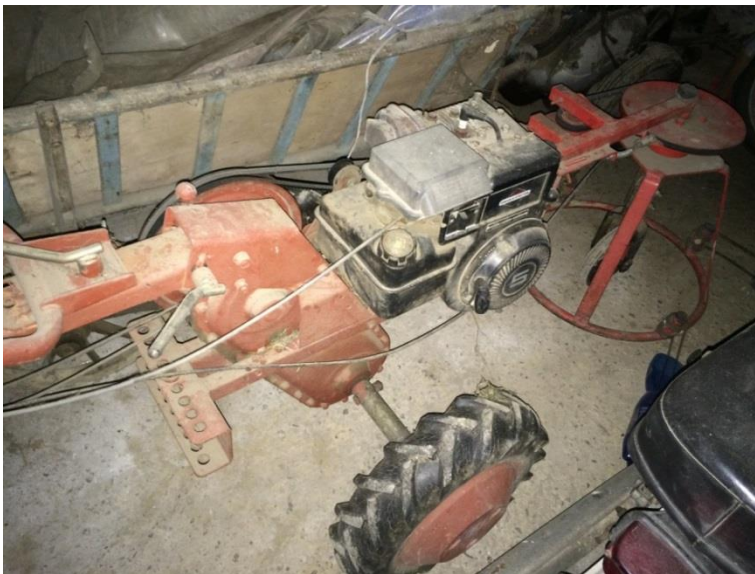
Obrázek 2-1 Motorový a pohonný systém rotační sekačky z 90. let (Jílek, 2015)
