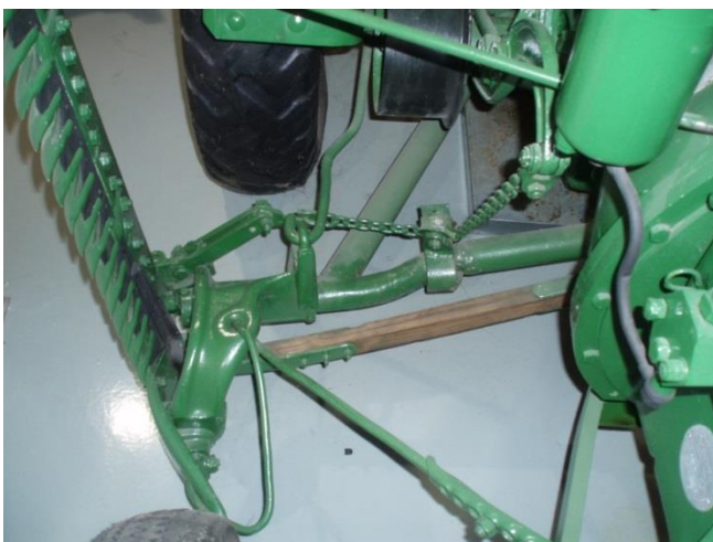
Obrázek 2-9 Lištová sekačka – kinematický mechanismus přidavného sekacího zařízení na traktoru (Jílek, 2015)
