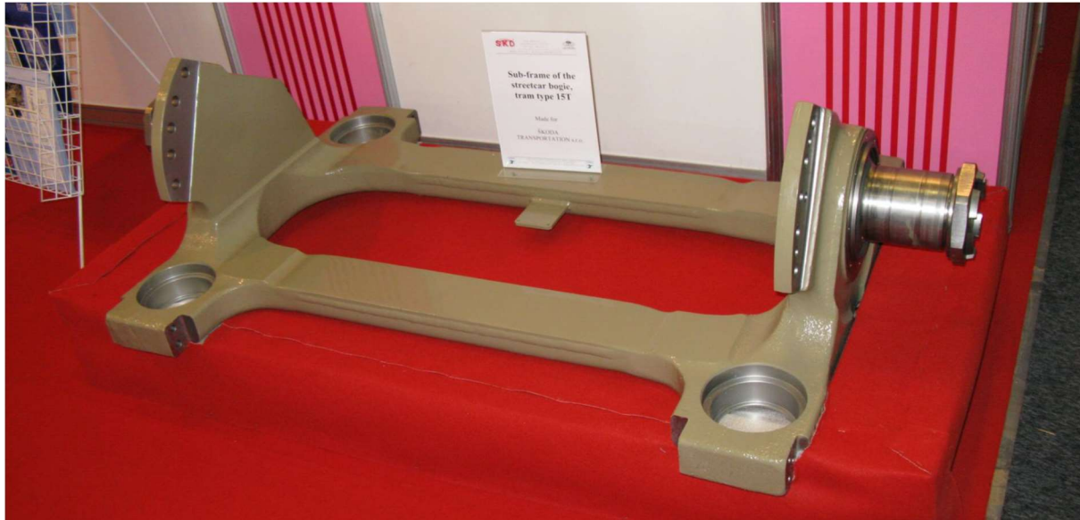
Obrázek 22 Nápravnice tramvaje Škoda 15T (23)
