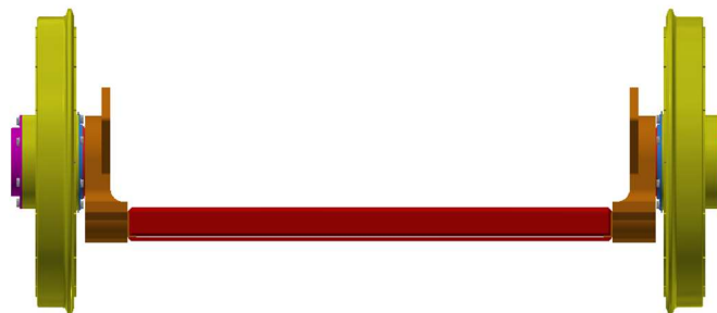
Obrázek 13 Nápravnice s volně otočnými koly (Vlastní zdroj)
