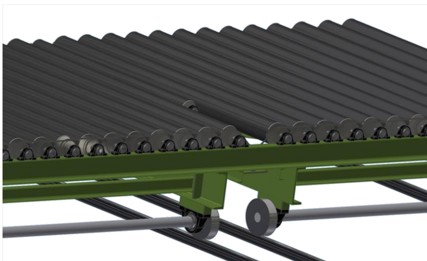
Obr. 14 Ložná plocha kolejového vozíčku
