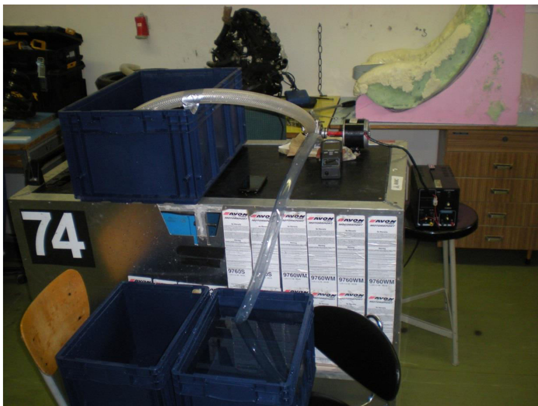
Obr. 4 Měření průtoků vodní pumpy
