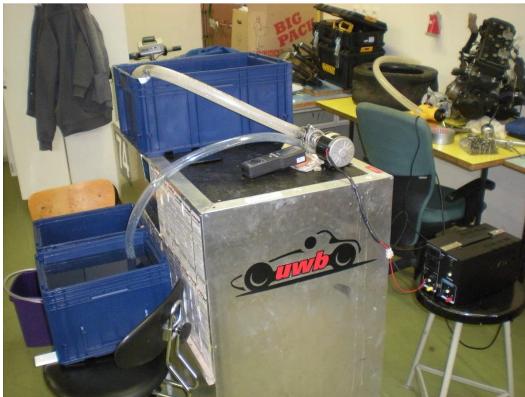
Obr. 2 Měření průtoků vodní pumpy
