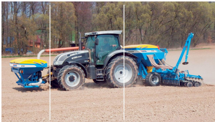
Obr. 2: Uspořádání strojů u secí kombinace. Zleva: čelní zásobník, traktor s dopravním potrubím, secí stroj /výsevní stroj. Viz [9]
