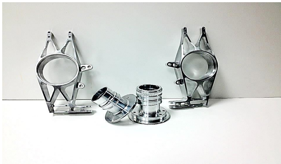
Obrázek 4 Obrobená těhlice týmu ILLinoi [4]
